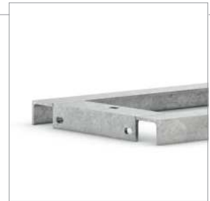
Grundrahmen aus verzinktem Winkelstahl, 60 x 40 mm (Materialstärke 5 mm) - Bodenbefestigung und Reihenverbindung möglich
